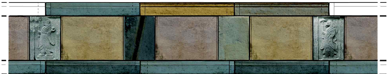
삽도 7. 추정 왕릉지 복원 모식도(호석 전개도 및, 상대감석 결구 상태)
