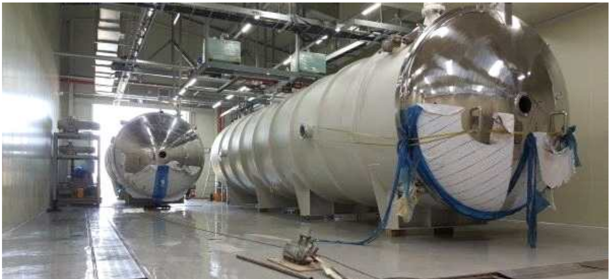
대형 진공동결건조기 예시(10m, 나주시 천연색소산업화지원센터 식품 건조용)
