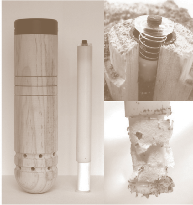
▲ 흰개미 예찰제어기의 외형과 흰개미 가해 전 베이트의 모습(왼쪽), 흰개미 가해 후 올라간 가해여부 표시장치의 모습(오른쪽 위)과 내부 유인체의 모습(오른쪽 아래). (사진제공: 문화재청)
