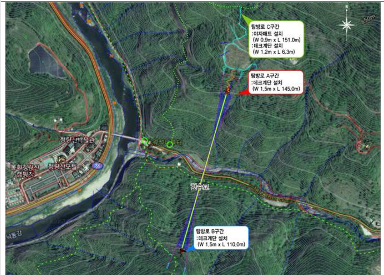
인도교(출렁다리) 설치 및 탐방로 정비 계획 전체 도면
