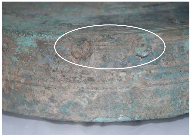
그림5. 鎔湯의 鑄入口 및 공기배출구
